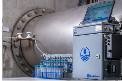
Beispiel eines Enzymaktivitäts Messgerätes für kontinuierliche und manuelle Messungen im Wasserwerk
